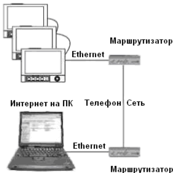
Рисунок 17 – Пример организации удаленного контроля с помощью веб-браузера
